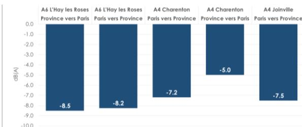
Figure 8: Evolution avant / après remplacement du revêtement de chaussée ; indicateur LAeq 24h.
