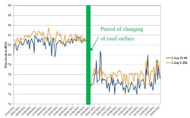
Figure 4: Diminution des niveaux de bruit diurnes et nocturnes à proximité de la source (terre-plein central) après le changement de revêtement de chaussée.
